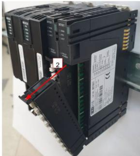
2) Нажмите на кнопку сверху модуля ввода/вывода или модуля питания и вытащите его по прямой линии.
